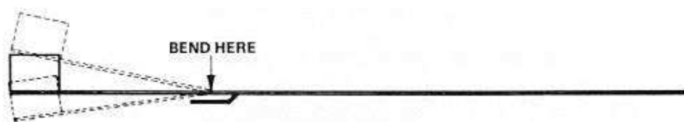
Schéma 4-6. Réglage de l'alignement du bras de l'étouffoir RHODES
